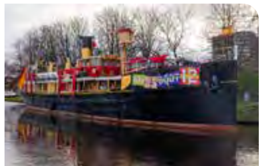
Pakjesboot 12 N.O.T.K. Stoomboot, 40,5 x 6,7 x 1,8, 297 ton Hoofdmotor 2x Stoommachine, 411 pk, Bj. 1910
